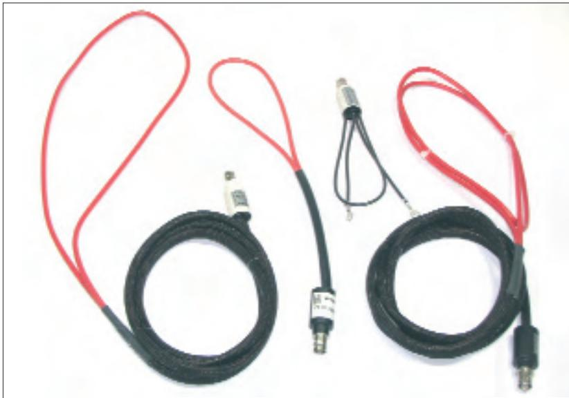
Bild 10: Eichhoff-Koppelschleifen
