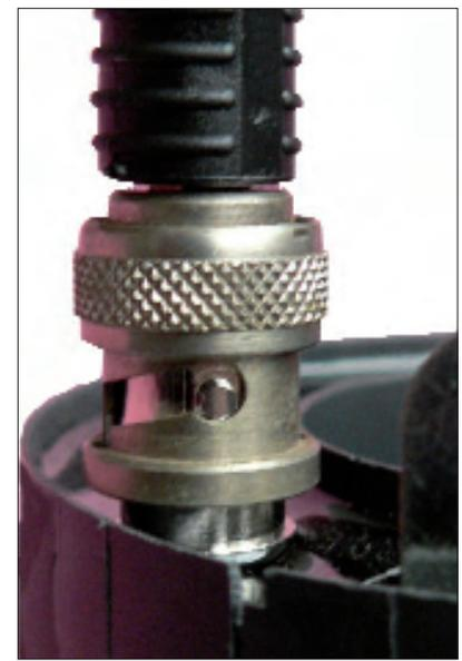
Bild 7: Integrierte BNC-Anschlussbuchse
